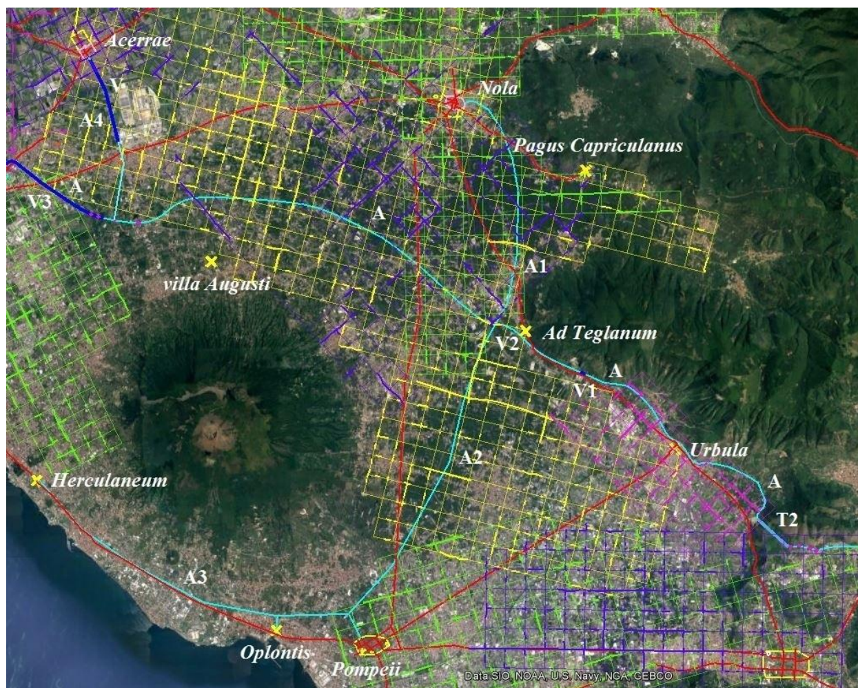
Figura 3 – Segmenti 3 e 4. A = Aqua Augusta del Serino; A1 = diramazione per Nola ; A2 = diramazione per Pompeii ; A3 = possibile diramazione per Herculaneum ; A4 = diramazione per Acerrae ; T2 = traforo del monte Paterno; V1 = mura d'Arce; V2 = località Ponte Tirone; V3 = grande ponte canale di Pomigliano d'Arco; V = possibile tratto su arcate.
