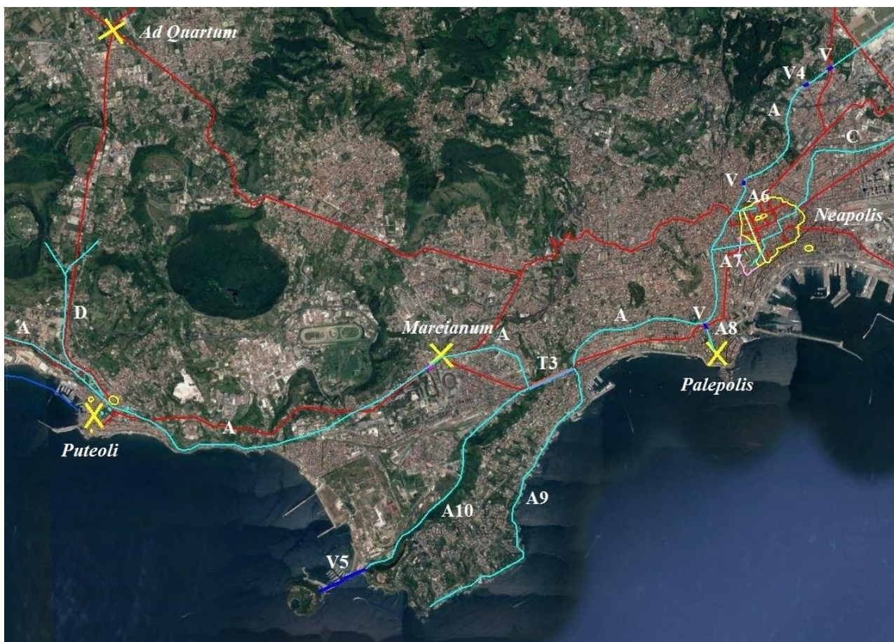
Figura 9 – Segmenti 7 e 8. A = Aqua Augusta del Serino; V4 = Ponti Rossi; V5 = ponte-canale sul mare; V = possibili tratti su arcate; T3 = traforo di Fuorigrotta; A6 = prima diramazione per Neapolis ; A7 = seconda diramazione per Neapolis ; A8 = diramazione per Palepolis ; A9 = diramazione per Pausilypon ; A10 = diramazione per Nisida ; C = acquedotto del Bolla; D = acquedotto del Gauro.
